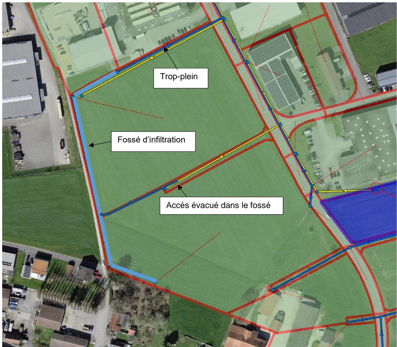
Figure 12 : Fossé et canalisation de trop-plein pour l'évacuation des eaux pluviales de la zone A
