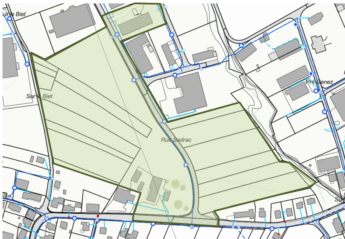
Figure 28 Réseau d'eau potable communal existant (en bleu)
