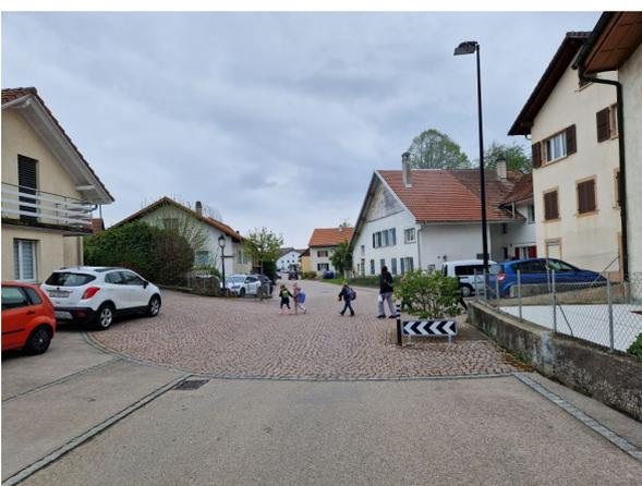
Gros déficit de visibilité pour une traversée importante, aide à la traversée non-conforme et située dans une zone à 50km/h
